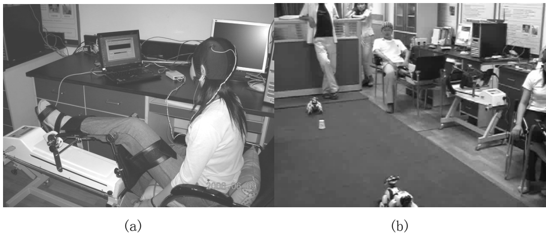
图 5.3 想象运动脑-机接口系统的应用：(a) 康复训练辅助系统；(b) 机器人运动控制系统。
