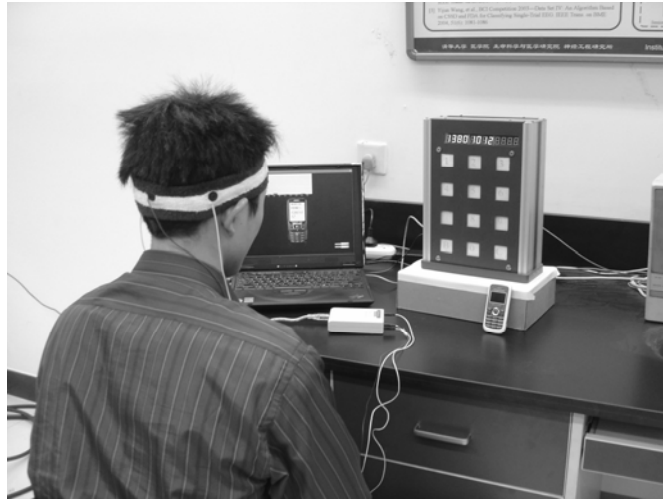
图 7.10 SSVEP 脑-机接口电话拨号演示系统
